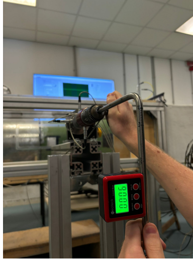
Figura 8: Settaggio asse di applicazione della forza nel test di caratterizzazione della bilancia multi-componente.
