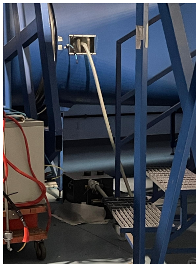
Figura 5: Serbatoio di aria compressa utilizzato per l' inseminamento del flusso.
