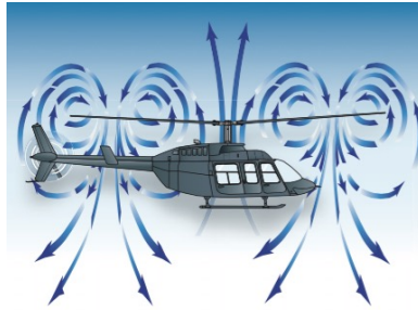
Figura 11: Sketch del fenomeno di vortex ring state.
